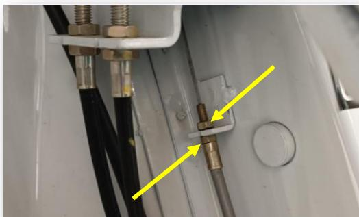
En caso de necesitar un ajuste mínimo puede realizarse desde la tuerca y contra tuerca de la funda del chicote situada en la parte inferior izquierda del tablero.
