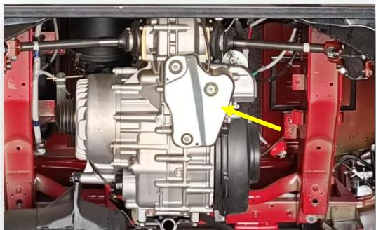
Por la parte inferior del motor encontraremos una placa indicada por la flecha amarilla que esta sujetada con 3 tornillos métrica 10, retire los 3 tornillos para tener acceso a la leva de reversa.
