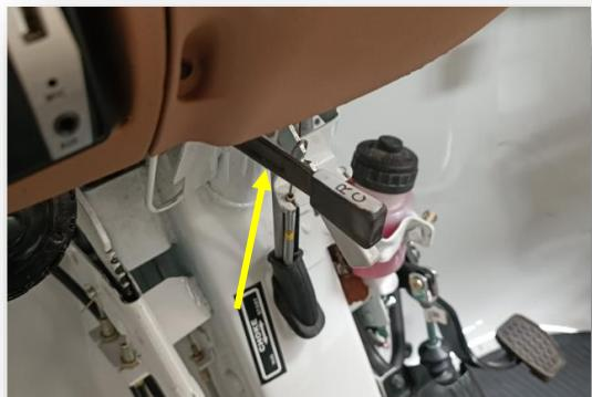
Para comenzar el ajuste del chicote asegurese que la palanca de reversa esta en la posición de descanso y completamente hacia arriba, así como también que la unidad este en Neutral para poder hacer el ajuste.
