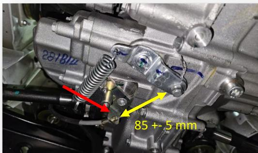
Mida la distancia entre la base ( flecha roja ) que sujeta la funda del chicote y la leva de reversa, la distancia entre estos dos elementos debe ser de 87 mm +/- 5 mm, si esta fuera de especificación ajuste el chicote y posterior apriete el prisionero.
